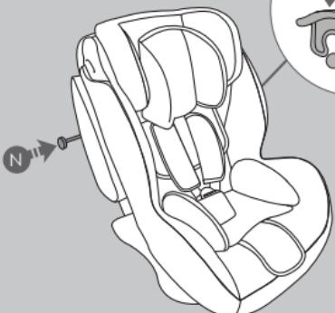
Επαναφέρετε την πλάτη του καθίσματος στην οριζόντια θέση. Τοποθετήστε πλήρως τη μπάρα στερέωσης (N) και μπλοκάρετε την στην αντίθετη πλευρά περιστρέφοντας προς τα κάτω το γάντζο μπλοκαρίσματος της μπάρας πλάτης, μέχρι να ακουστεί το "κλικ" του μπλοκαρίσματος (0).
