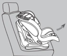
Coloque la sillita en el asiento del pasajero. Regule la sillita en la posición más reclinada. Presione la manija de regulación situada bajo la parte frontal del asiento de la sillita y, manteniéndola presionada, tire hacia arriba el asiento hasta la posición más reclinada. Suelte la manija.
