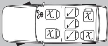
Il seggiolino può essere utilizzato solo con cinture di sicurezza a 3 punti (A) e NON con cinture di sicurezza a 2 punti (B).
