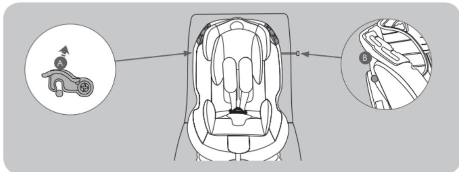
Rodar para cima o gancho de bloqueio da barra de encosto (A) ao lado do assento e retirar no lado oposto a barra de fixação (B) para fora.
