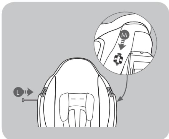
Recolocar o encosto do assento em posição original. Inserir completamente a barra de fixação (L) e bloqueá-la no lado oposto rodando para baixo o gancho (M) de bloqueio da barra de encosto até ouvir um “clique” que indica o seu bloqueio. Verificar puxando a barra que esta não saia e que esteja corretamente montada e bloqueada.
