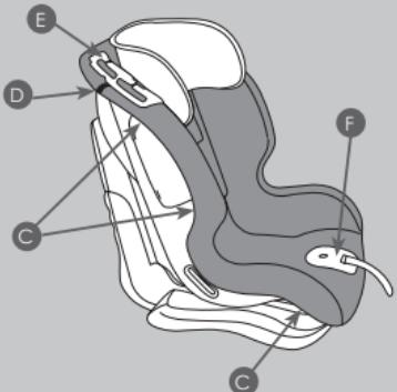
O revestimento está bloqueado na armação por uma série de ganchos (C) colocados na parte traseira e inferior da armação. Soltar os ganchos da cobertura para remover o revestimento. Soltar o velcro® (D). Para remover o revestimento dos passantes guia do cinto (E) puxar ligeiramente o tecido de debaixo do gancho e retirá-lo. Para remover o tecido da proteção em plástico (F) puxar ligeiramente o tecido dedeabaixo da proteção em plástico e retirá-lo.
