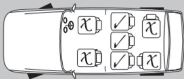
O banco pode ser utilizado apenas com cintos de segurança com 3 pontos (A) e NÃO com cintos de segurança com 2 pontos (B). A cadeira deve estar instalada na posição de marcha para a frente nos bancos traseiros do veículo, utilizando os cintos de segurança de 3 pontos fornecidos com o veículo, para a fixação.
