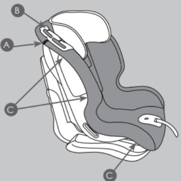
El revestimiento influye directamente en el funcionamiento del dispositivo de sujeción por lo que se refiere a la seguridad. Nunca utilice la sillita para coche sin el revestimiento. Vuelva a colocar el revestimiento en el bastidor de la sillita, tire de la parte elástica para que se adhiera correctamente el revestimiento al bastidor, alrededor de las guías del cinturón (B) en la parte superior de la sillita.
