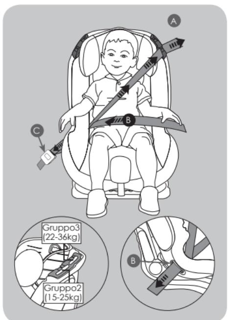
Assicurare il bambino utilizzando la cintura a 3 punti, in dotazione al veicolo, facendo passare la cintura pettorale nel passante (A) nella posizione più bassa per l'utilizzo con bambini del GRUPPO 2 (da 15 a 25 kg), nel passante (A) nella posizione più alta per l'utilizzo con bambini del GRUPPO 3 (da 22 a 36 kg).
