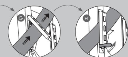
Για να μπλοκάρετε τη θωρακική ζώνη με τη διάταξη "κλιπ μπλοκαρίσματος θωρακικής ζώνης" προχωρήστε ως εξής: Κατεβάστε το κουμπί (E) και ανασηκώστε το κλιπ διακοπής (F). Περάστε τη θωρακική ζώνη κάτω από το κλιπ διακοπής και τεντώστε τη θωρακική ζώνη για να εξαλειψίσετε ενδεχόμενα παιχνίδια. Κατεβάστε το κλιπ (G) και ανασηκώστε το κουμπί (H). Για να διευκολύνετε το κλείσιμο, πατήστε το κλιπ διακοπής και ανασηκώστε το κουμπί. Βεβαιωθείτε για το σωστό μπλοκάρισμα.
