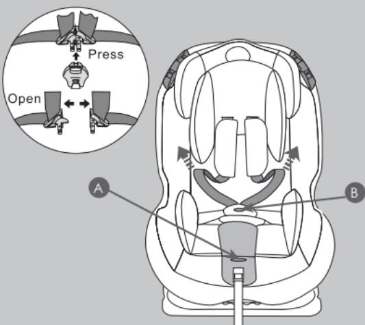
Asegúrese de haber instalado correctamente la sillita siguiendo las indicaciones incluidas en el apartado "Montaje para el GRUPO 1 (de 9 a 18 kg)". Presione el botón (A) y tire del cinturón (cinturón pectoral) asiéndolo por la parte inferior, por debajo de los acolchados de las protecciones pectorales para aflojarlas. Presione el pulsador (B) y desenganche los cinturones.
