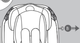
Rodar para cima o gancho de bloqueio da barra de encosto (A) ao lado do assento e retirar do lado oposto a barra de fixação (B) para o exterior.
