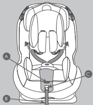
Levante el revestimiento que cubre el pulsador de regulación, en la parte delantera de la sillita.
