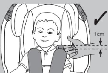
La regolazione ideale dell'imbracatura è tale da consentire l'inserimento di un dito (1cm) nella parte superiore sopra la spalla.
