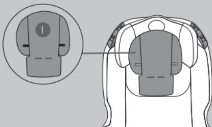
Αφαιρέστε το υποστήριγμα κεφαλής, αποσυνδέοντας τις δύο γλωσσίδες του Βέλκρου® από κάθε πλευρά στο πίσω μέρος του υποστηρίγματος κεφαλής (I).
