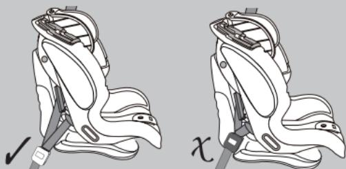
Tras la instalación, controle que la sillita esté bien fijada en el asiento; moviéndola lateralmente, la oscilación lateral debe ser mínima.
