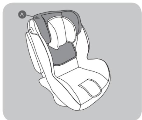
Η επένδυση έχει άμεση επίπτωση στη λειτουργία της διάταξης συγκράτησης από την άποψη της ασφάλειας. Μη χρησιμοποιείτε ποτέ το καρεκλάκι αυτοκινήτου χωρίς την επένδυση.
