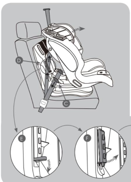
Βεβαιωθείτε ότι η ζώνη ασφαλείας του οχήματος δεν είναι στριμμένη και ότι είναι σωστά αγκιστρωμένη. Σπρώξτε το περιβλήμα του μικρού καθίσματος για μωρά για να εφαρμόσει καλά στο κάθισμα επιβάτη. Περάστε το οριζόντιο μέρος, κοιλιακή ζώνη, κάτω από τους γάντζους (C) και τεντώστε τη ζώνη, τραβώντας τη θωρακική ζώνη για να μειωθεί το παιχνίδι της. Περάστε τη θωρακική ζώνη, στη διάταξη μπλοκαρίσματος (D) "κλιπ"
