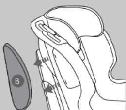
Remover as almofadas de proteção lateral (B) puxando em direção das setas, para libertá-las da armação e remover então o revestimento das proteções.
