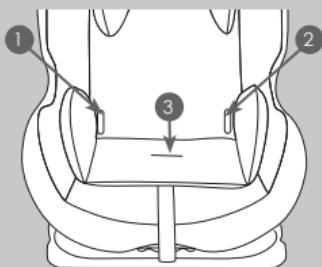
Inserir os anéis metálicos (C) da parte abdominal do cinto nas aberturas (1) e (2) do revestimento e através das aberturas externas na armação. Inserir na parte traseira da armação, os anéis metálicos (C) através das aberturas internas.
