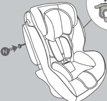
Recolocar o encosto do assento em posição original. Inserir completamente a barra de fixação (N) e bloqueá-lo pelo lado oposto rodando para baixo o gancho de bloqueio da barra de encosto, até ouvir um "clique" que indica o seu bloqueio (O). Verificar puxando a barra que esta não saia e que esteja corretamente montada e bloqueada.
