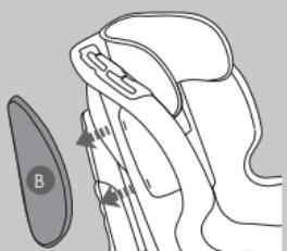
Quite los cojines de protección lateral (B), tirando de ellos en la dirección indicada por las flechas para desengancharlos del bastidor, y después quite el revestimiento de las protecciones. El revestimiento está bloqueado en el bastidor por una serie de ganchos (C) situados en la parte trasera inferior del bastidor.
