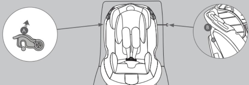
Ruotare verso l'alto il gancio di bloccaggio barra schienale (A) a lato seduta e sfilare dal lato opposto la barra di fissaggio (B) verso l'esterno.
