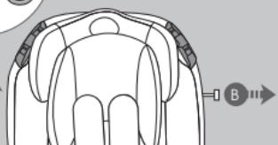
Ruotare verso l'alto il gancio di bloccaggio barra schienale (A) a lato seduta e sfilare dal lato opposto la barra di fissaggio (B) verso l'esterno.
