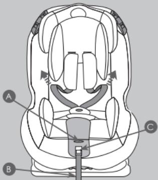
Quando il bambino cresce, supera la configurazione di utilizzo del GRUPPO 1 (da 9 a 18kg), il seggiolino auto deve essere trasformato per l'utilizzo nel GRUPPO 2 (da 15 a 25 kg) o per il GRUPPO 3 (da 22 a 36 kg). In questa configurazione è necessario rimuovere la cintura a 5 punti (imbracatura) in dotazione al seggiolino auto.
