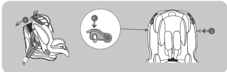
Riportare lo schienale della seduta in posizione originale (I). Facendo attenzione a non bloccare la cintura pettorale. Inserire completamente la barra di fissaggio (J) e bloccarla dal lato opposto ruotando verso il basso il gancio di bloccaggio barra schienale, fino ad udire lo scatto "click" che ne indica l'avvenuto bloccaggio (K). Verificare tirando la barra che questa non si sfilo e che sia correttamente montata e bloccata.
