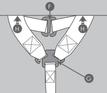
Desenganche las correas del arnés por la parte trasera del respaldo, soltando las correas de las protecciones pectorales del gancho (F) y soltando los dos cinturones pectorales del estribo de tensado del cinturón (G). Pase el cinturón a través de las ranuras presentes en la parte trasera del bastidor (H).
