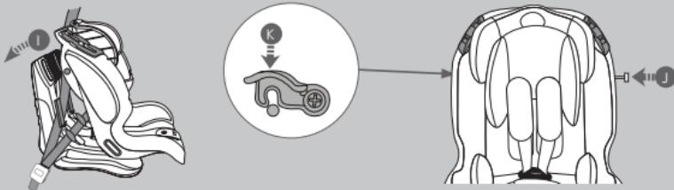
Sitúe el respaldo del asiento en la posición de origen (I). Procure no bloquear el cinturón pectoral. Introduzca completamente la barra de fijación (J) y bloquéela por el lado opuesto, girando hacia abajo el gancho de bloqueo de la barra del respaldo, hasta que note el "clic" que indica que se ha bloqueado (K). Compruebe, tirando de la barra, que ésta no se mueva y que esté bien montada y bloqueada.
