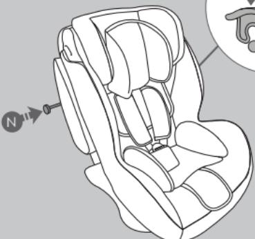
Riportare lo schienale della seduta in posizione originale. Inserire completamente la barra di fissaggio (N) e bloccarla dal lato opposto ruotando verso il basso il gancio di bloccaggio barra schienale, fino ad udire lo scatto "click" che ne indica l'avvenuto bloccaggio (O). Verificare tirando la barra che questa non si sfilo e che sia correttamente montate e bloccata.
