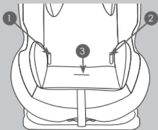
Después de haber enganchado la hebilla, tendrá un arnés parecido al dibujo presentado en el Introduzca los anillos metálicos (C) de la parte abdominal del cinturón en las guías (1) y (2) del revestimiento y a través de las ranuras externas en el bastidor. Introduzca por la parte trasera del bastidor, los anillos metálicos (C) a través de las ranuras internas.
