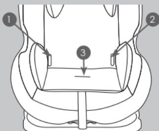
Inserire gli anelli metallici (C) della parte addominale della cintura nelle asole (1) e (2) del rivestimento e attraverso le fessure esterne sulla scocca. Inserire dalla parte posteriore della scocca, gli anelli metallici (C) attraverso le fessure interne. Assicurarsi del corretto inserimento e bloccaggio.
