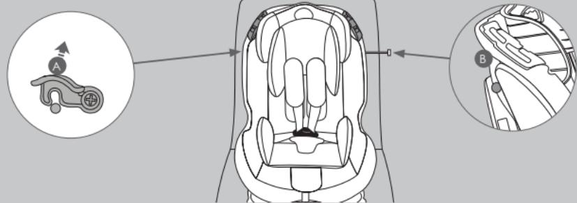
Gire hacia arriba el gancho de bloqueo de la barra del respaldo (A), situado al lado del asiento, y deslice por el lado opuesto la barra de fijación (B) hacia fuera. Recline hacia delante el respaldo de la sillita, pase el cinturón de tres puntos, del vehículo, entre el bastidor de la sillita y la base. Enganche el cinturón de seguridad a la hebilla.
