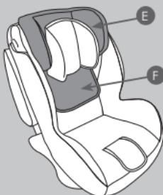
Acople el revestimiento al cojín de protección lateral (D), y siguiendo las direcciones de las flechas de la figura, enganche el cojín al bastidor. Asegúrese del enganche correcto. Repita la operación con el segundo cojín de protección lateral. Vuelva a poner el revestimiento (E) en el reposacabezas, introduzca la parte inferior del revestimiento (F) por detrás del revestimiento principal de la sillita.
