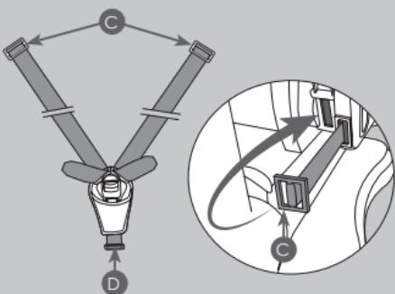
Τοποθετήστε το μεταλλικό δακτύλιο της βουβωνικής ζώνης μέσα από τις εγκοπές του μαξιλαριού, της επένδυσης και μέσα από τη σχισμή πάνω στο περίβλημα (3). Βεβαιωθείτε για τη σωστή τοποθέτηση και μπλοκάρισμα.
