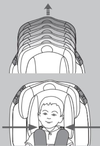
Regular o apoio da cabeça e os arneses, puxando o manípulo colocado na parte traseira do apoio de cabeça. Levantar ou abaixar o apoio da cabeça conforme a altura da criança.
