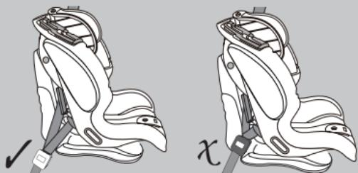
Após a instalação, certificar-se que a cadeira esteja corretamente fixada no banco tentando movê-la lateralmente; a oscilação lateral deverá ser mínima. Se for encontrada uma ampla oscilação, repetir a montagem certificando-se de esticar corretamente o cinto antes do seu bloqueio com o clip. Certificar-se que, após a instalação da cadeira, o fecho do cinto NÃO esteja posicionado na armação da cadeira.
