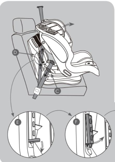
Para bloquear el cinturón pectoral con el dispositivo “clip de bloqueo del cinturón
