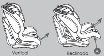
La sillita puede abatirse en 4 posiciones diferentes, desde la posición vertical a la posición más reclinada. Presione la manija de regulación situada debajo de la parte frontal del asiento de la sillita y, manteniéndola presionada, tire o empuje el asiento hacia delante o hacia atrás. Suelte la manija en la posición deseada y asegúrese de que el asiento esté bloqueado correctamente; notará un "clic" cuando se enganche.
