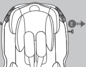
Gire hacia arriba el gancho de bloqueo de la barra del respaldo (D) situada al lado del asiento y deslicépor el lado opuesto la barra de fijación (E) hacia fuera.
